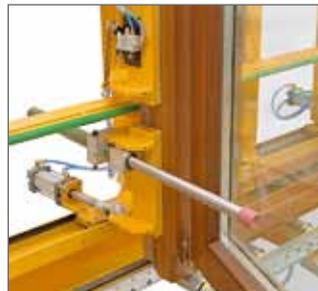
пневматический упор для фиксации створки в открытом положении
