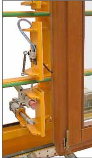
устройство безопасной фиксации для полуавтоматического цикла управления, монтируется на правом и левом фиксаторах
