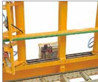
синхронизация перемещения левого и правого фиксатора при помощи зубчатых реек
